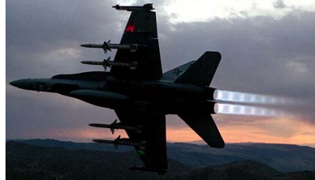
Figure 91: Urti all'uscita di un ugello sottoespanso.
